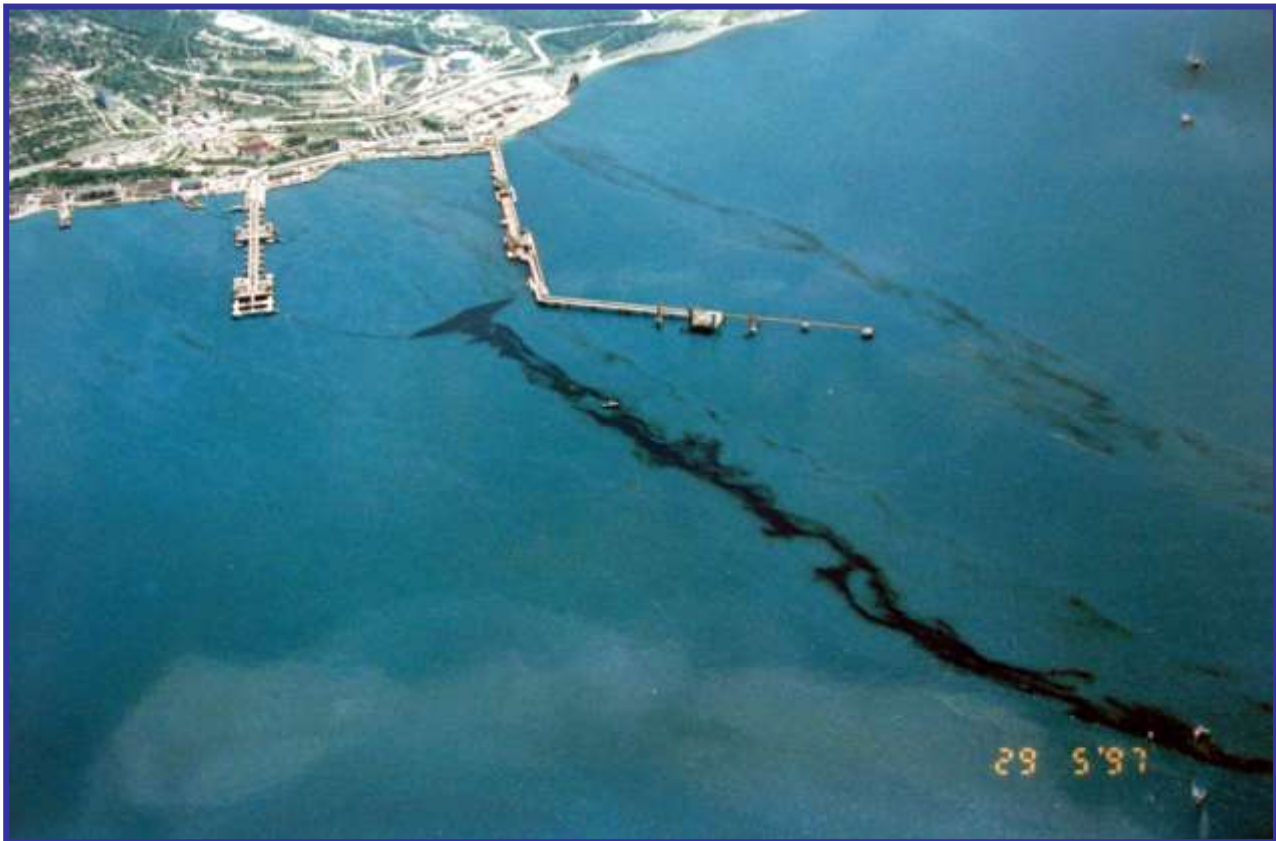
Рис.13. Пример неэффективной работы бонового заграждения
